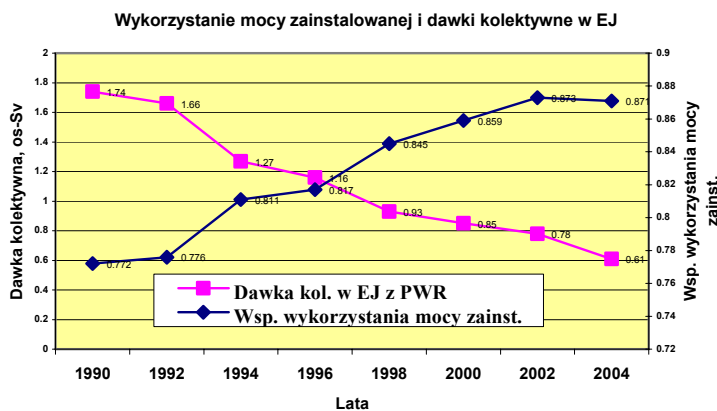
Rys. 1 Wzrost współczynnika wykorzystania mocy zainstalowanej w EJ na świecie i obniżanie średniej dawki kolektywnej na rok pracy bloku z reaktorem PWR. Dane z [1].
